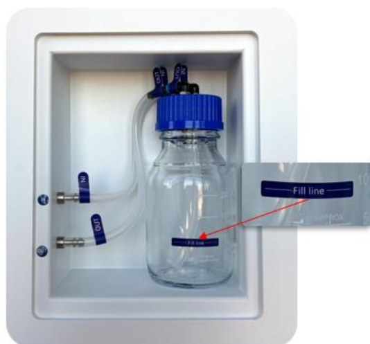
Figura 21.1 Conectarea tubului la flaconul de umidificare și la stația de lucru Multi-Zone ART
