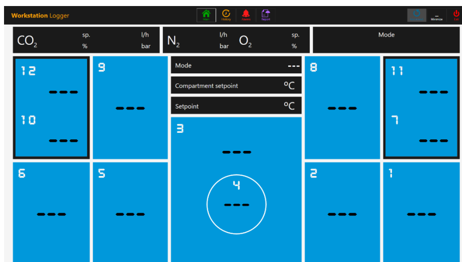
Figura 23.5 Afișajul principal al Software-ului de înregistrare date al stației de lucru în cazul pierderii semnalului
