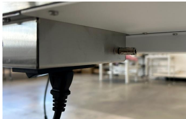
Figura 11.1 Intrare gaz sub masa tip Mono
