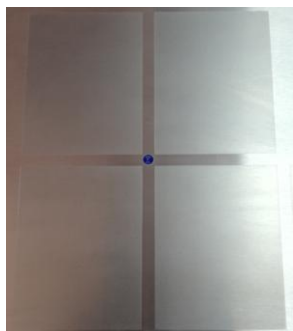
Figura 11.7 Duză pentru gaz în masa de lucru
